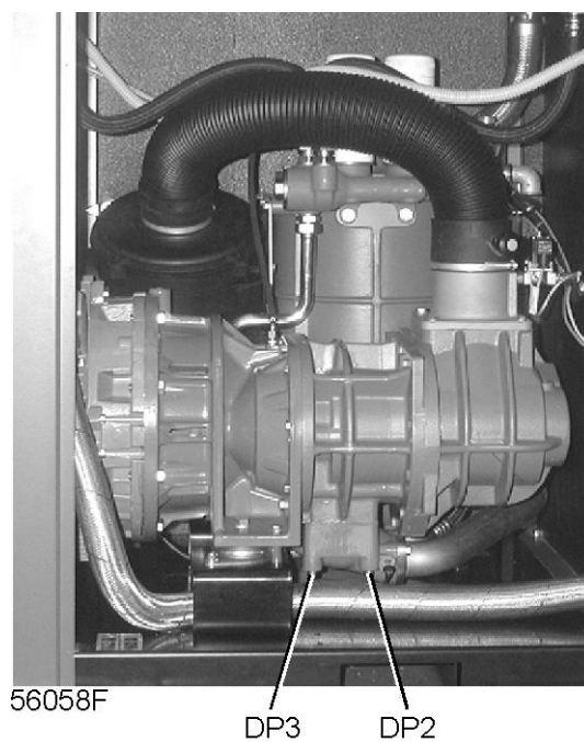
Заглушки маслоливных отверстий компрессоров GA 75 VSD и GA 90 VSD
